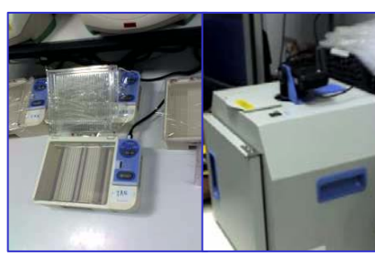
電気泳動装置にかけ、得られた泳動波形よりDNA解析を行い菌同定
