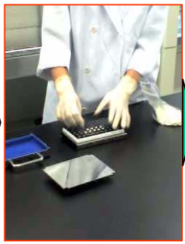
凍結乾燥粉末を飲みやすいカプセルに充填、カプセルに腸溶性コーティングを施す
