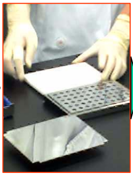
凍結乾燥粉末を飲みやすいカプセルに充填、カプセルに腸溶性コーティングを施す
